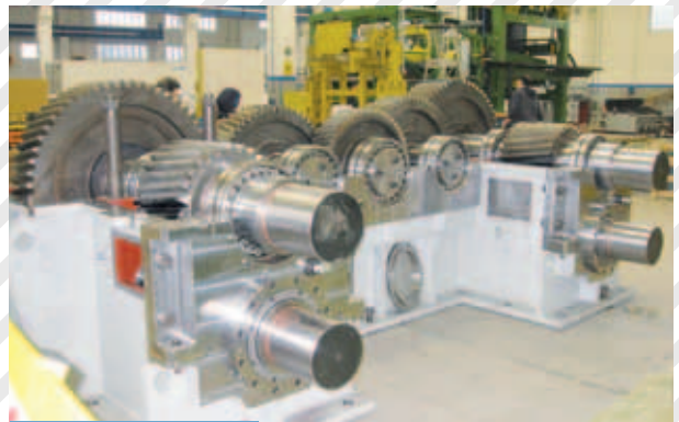
8. Assemblaggio riduttori Gearbox Assembly
