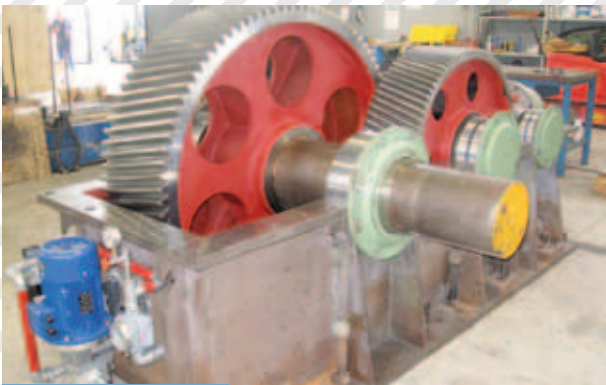
7. Revisione riduttori Gearbox Reconditioning
