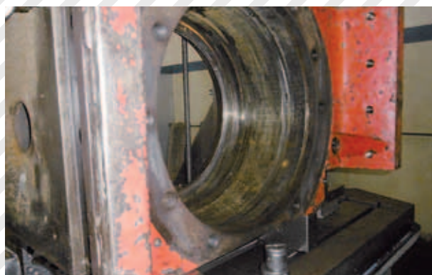
10. Ricondizionamento guarnitura Chock Reconditioning
