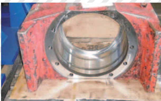
7. Ricondizionamento guarnitura Chock Reconditioning
