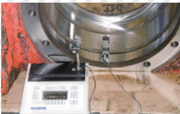
9. Ricondizionamento guarnitura Chock Reconditioning
